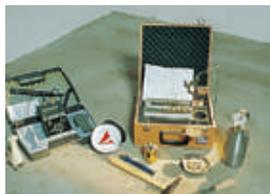
Comprobar la humedad de la solera y la temperatura y humedad del aire.
