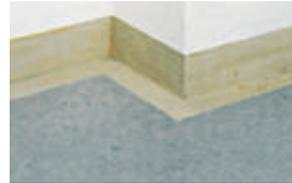
Pavimento completamente pegado a la solera con un espacio a la pared
