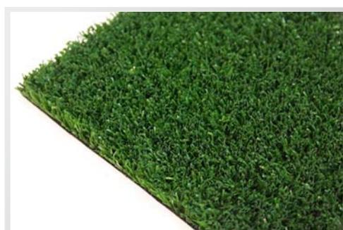
• Césped artificial de 14mm de altura total, diseñado para la práctica de pádel, tenis, o multideporte, fabricado mediante "tufting" con hilo monofilamento, de cinta plana de polietileno
