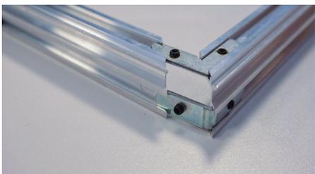
En cada esquina se coloca una escuadra y un ángulo y seguidamente se aprietan los tornillos allen
