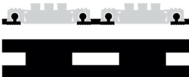
Composición: PVC plastificado de dureza SHORE A95
