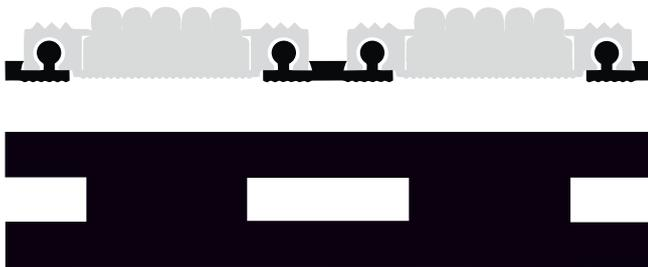
Composición: PVC plastificado de dureza SHORE A95
