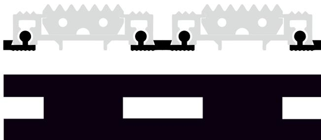
Composición: PVC plastificado de dureza SHORE A95
