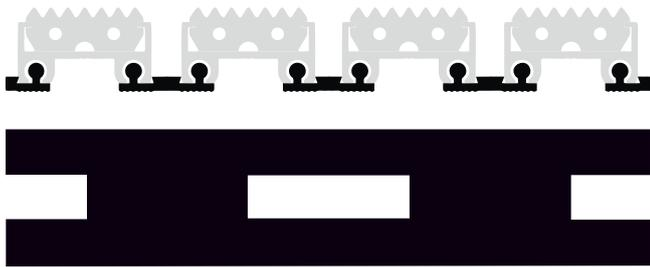
Composición: PVC plastificado de dureza SHORE A95
