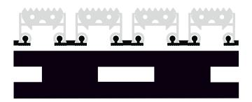
Composición: PVC plastificado de dureza SHORE A95
