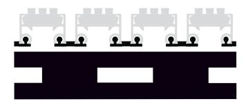
Composición: PVC plastificado de dureza SHORE A95
