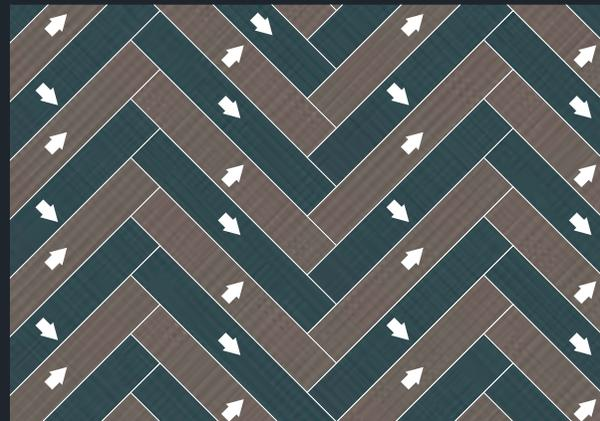
*Instalación en espigas realizada en dos colores con lamas colocadas en el sentido de la urdimbre y en el sentido de la trama.*
