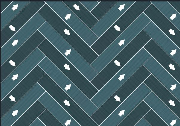
*Instalación en espigas realizada en un solo color con lamas colocadas en el sentido de la urdimbre y en el sentido de la trama.*
