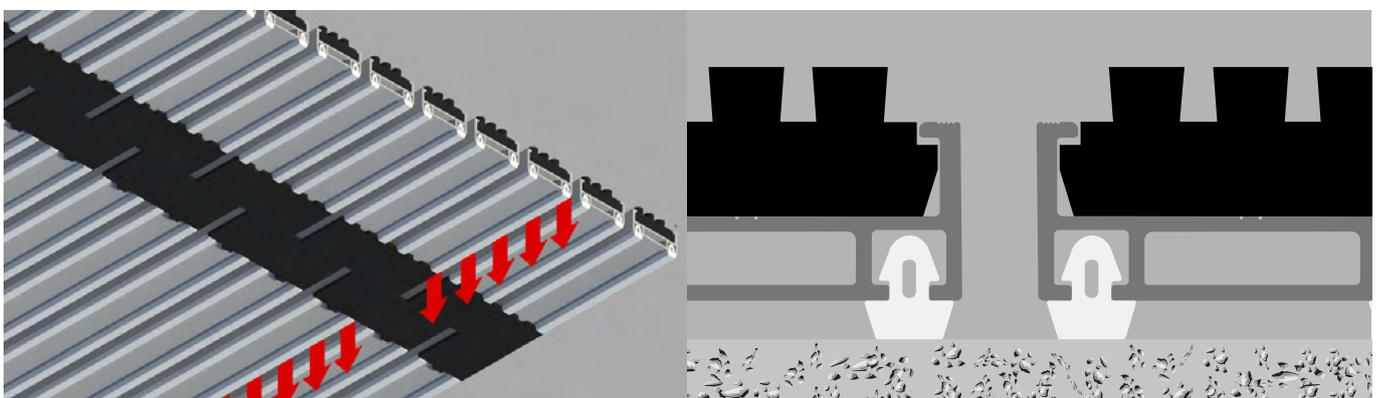
La característica principal que hace a EXPERT superior radica en su innovador sistema de unión entre perfiles mediante bisagra de plástico, que permite que TODA la suciedad retenida sea retirada fácilmente, bastará con enrollar el felpudo y aspirar o barrer
