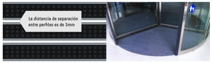
La norma DIN 18650 establece que la distancia de separación entre perfiles no debe exceder 3mm para aquellos felpudos instalados en puertas automáticas
