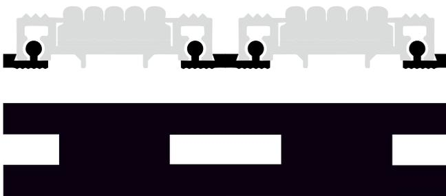
Composición: PVC plastificado de dureza SHORE A95
