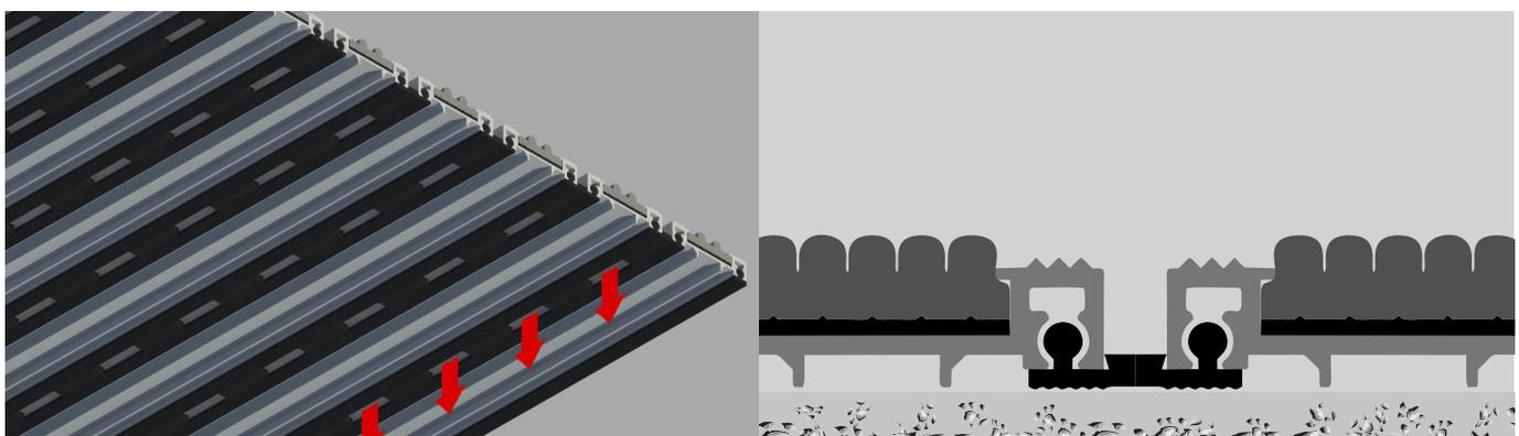
Se caracteriza por su sistema de unión entre perfiles mediante junta de PVC plastificado de alta resistencia, que permite que el felpudo sea fácilmente enrollable, para facilitar tanto su manipulación, como la recogida de la suciedad capturada, acumulada en el foso en el que se aloja. Además, está perforada, para permitir la evacuación de polvo y humedad
