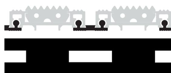
**Composición:** PVC plastificado de dureza SHORE A95
