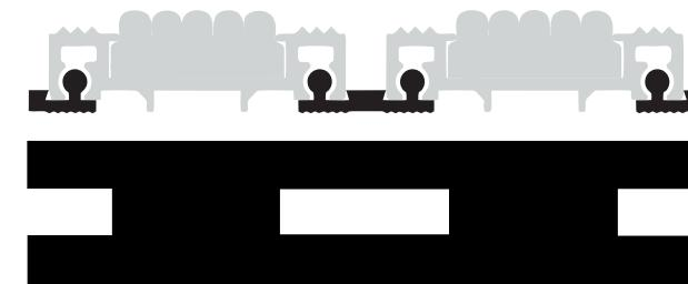
**Composición:** PVC plastificado de dureza SHORE A95
