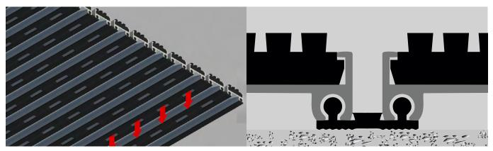
Se caracteriza por su sistema de unión entre perfiles mediante junta de PVC plastificado de alta resistencia, que permite que el felpudo sea fácilmente enrollable, para facilitar tanto su manipulación, como la recogida de la suciedad capturada, acumulada en el foso en el que se aloja. Además, está perforada, para permitir la evacuación de polvo y humedad
