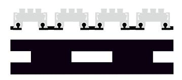
Composición: PVC plastificado de dureza SHORE A95
