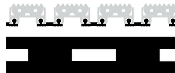
**Composición:** PVC plastificado de dureza SHORE A95
