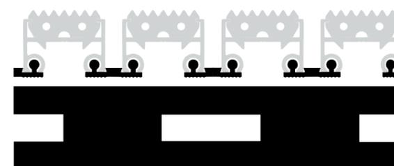
**Composición:** PVC plastificado de dureza SHORE A95
