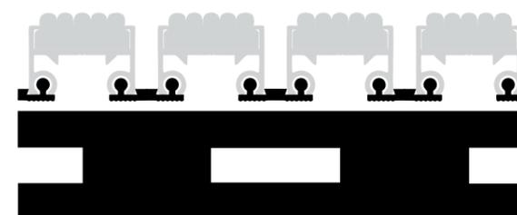
**Composición:** PVC plastificado de dureza SHORE A95
