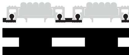
**Composition:** PVC plastifié de dureté SHORE A95**Poids:** 80 grammes / mètre linéaire**Forage de drainage:** 6x22 mm pour chaque 44 mm de long
