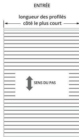
Pour les tapis dont la longueur du profilé est inférieure à 5 mètres en partant du bord de chacun des quatre côtés du paillage au mur du creux auquel se loge doit être de 2 mm. En d'autres termes, le tapis doit mesurer 4 mm de moins de large et de long que les mesures intérieures du creux libre
