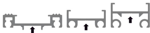
Para ello, en el diseño de los perfiles se ha previsto el alojamiento de una pletina de unión, que será incorporada en la fabricación a varios perfiles de una de las piezas de las que se compone el felpudo. La pieza contigua a ésta deberá ser desenrollada insertando el alojamiento de la pletina ("hembra") en dicha pletina de unión ("macho"). De este modo, apenas se apreciará la división en distintas piezas
