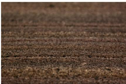
Está fabricado a partir de caucho proveniente del reciclado de neumáticos de camiones, autobuses y aviones
